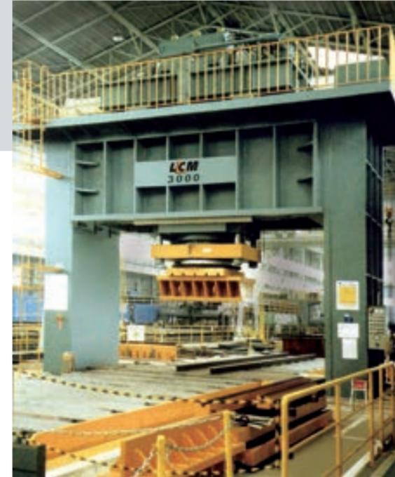
壓缸移動式造船油壓機
